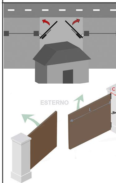
Se il cancello apre verso l'esterno della proprietà (vedi pag.9) Verificare l'ingombro del motore e seguire lo schema di fissaggio rispettando i limiti di misura A e B qui sotto riportati.
