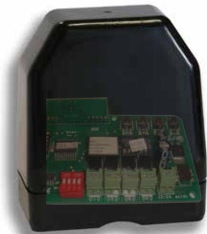
Il ricevitore radio a 4 canali permette di comandare fino a 4 dispositivi automatici anche di altre marche o marche con i radiocomandi Ducati rolling code. Ogni canale ha una capacità di memoria di 25 codici radio.
