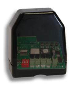
Il ricevitore radio a 4 canali permette di comandare fino a 4 dispositivi automatici anche di altre marche o marche con i radiocomandi Ducati rolling code Ogni canale ha una capacità di memoria di 25 codici radio.
