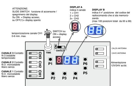
Il ricevitore radio a 3 canali permette di comandare fino a 3 dispositivi automatici con i radiocomandi DUCATI ROLLING CODE
