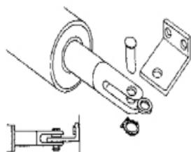
16 Fixez la plaque plate à la plaque multiposition à l'aide de boulons et d'écrous
