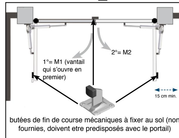
butées de fin de course mécaniques à fixer au sol (non fournies, doivent être prévues avec le portail)
