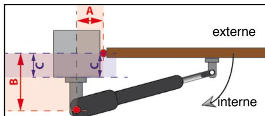
■ **A=** distance (en section, sur l'axe transversal) entre l'axe des gondes du vantail (V) et le pivot sur lequel tourne le vérin (K). Cette distance peut être choisie par l'utilisateur en respectant les limites spécifiques de son modèle de vérin. Il est conseillé de choisir une taille similaire à la taille B. En général: un plus grand A permet un plus grand angle d'ouverture.
