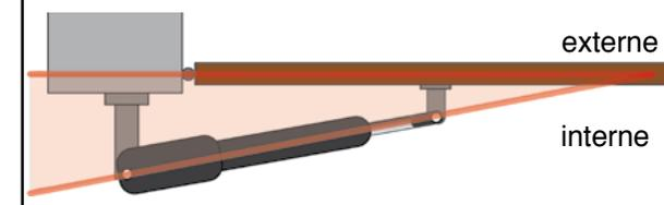
1) **Attention: ANGLE D'INCIDENCE.** Pour assurer une parfaite tenue du portail lors de la fermeture, il est nécessaire d'installer le vérin avec un angle d'incidence par rapport au portail fermé. De cette façon, le vantail sera maintenu bien contre la butée au sol.
