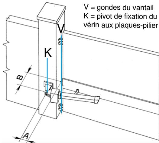
**Recommandation:** même sur des portails relativement petits et pas très longs (L), il est toujours préférable de choisir un vérin aussi long que possible afin de garantir une plus grande force de levier et ainsi assurer un rendement mécanique maximal, une usure moindre des charnières du portail et une plus grande durée de la plante.
