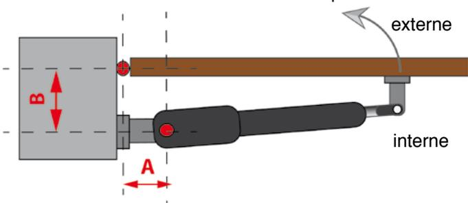
■ **A=** cette mesure doit permettre l'ouverture de la porte à 90°. Positionnez les plaques de fixation du moteur de manière à ce qu'elles permettent une ouverture géométrique de la porte à 90°. Il est conseillé une mesure A de min. 8 cm. l'espace utile pour le passage sera par conséquent réduit. Dans le cas d'un espace limité, il est conseillé d'installer le moteur en haut afin de ne pas gêner le passage des voitures.
