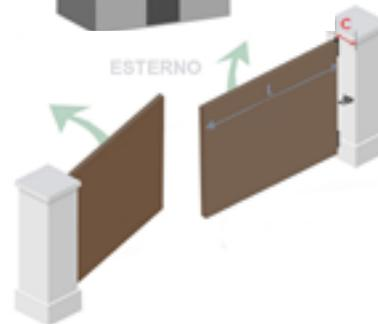
Wenn sich das Tor nach Außen hin öffnet (siehe Seite 9) das Ausmaß des Motors überprüfen und das Befestigungsschema mit den Messgrenzwerten A und B befolgen.
