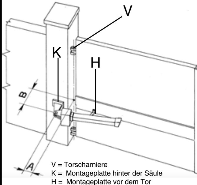
■ **A** = Entfernungsmessung ( an der Längsachse) zwischen der Torangel und dem Zapfen an welchem sich der Antrieb dreht. Dieser Abstand kann vom Benutzer in Übereinstimmung mit den spezifischen Grenzwerten für das Triebwerkmodell ausgewählt werden. Sie sollten ein Maß ähnlich dem B Maß wählen
