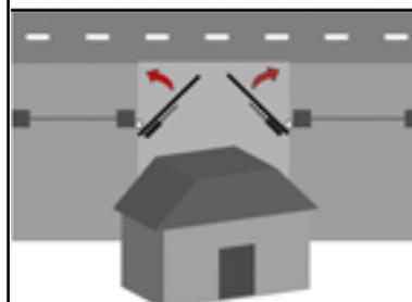
Wenn sich das Tor nach Außen hin öffnet (siehe Seite 11) das Ausmaß des Motors überprüfen und das Befestigungsschema mit den Messgrenzwerten A und B befolgen.
