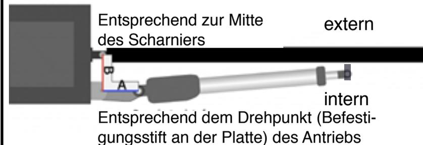
■ **A** = Gemäß dem Motor Ausmaß und der Mitte des Tor-Scharnier, muss diese Abmessung die Öffnung des Flügels zu 90 ° ermöglichen. Positionieren Sie die Motor-Befestigungsplatten so, dass es geometrisch möglich ist die Flügel zu 90 ° zu öffnen. Achtung: der Spielraum der Einfahrt wird, auf Grund der Sperrigkeit des Motors, entsprechend reduziert. Wenn wenig Platz vorhanden ist, wird empfohlen, den Motor auf der Oberseite zu installieren, um die Durchfahrt der Autos nicht zu
