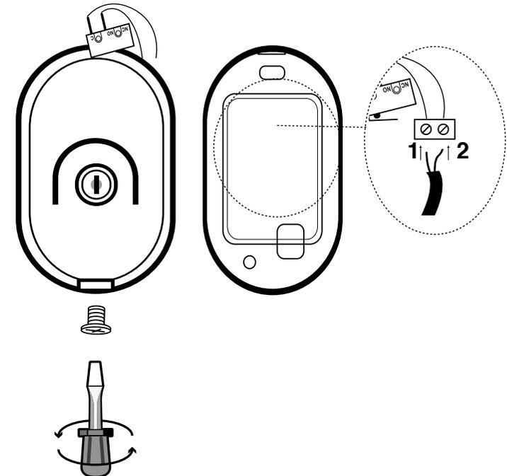
Das Blinklicht zeigt das Tor in Bewegung an (Öffnen und Schließen). Das Blinklicht muss am Pfeiler/Mauer montiert werden, so dass es von innen und aussen gut sichtbar ist. Das Blinken ist beim Öffnen langsam und bei Schliessen schnell. Die Montage des Blinklichts ist notwendig und obligatorisch um die Sicherheit der Zone eines öffentlichen Durchganges zu garantieren.
