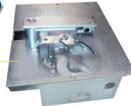
Motorizzazione interrata offre una soluzione completamente invisibile ideale su cancelli ornamentali. Motoriduttore installato sotto il suolo in apposite casse, permette l'apertura delle ante fino a 180°. Per ante fino a 2,5m di larghezza. Non avendo un ingombro fuori terra è compatibile con qualsiasi struttura. Ideale anche in caso di pilastri molto grandi e profondi.
